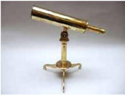
était utilisé pour l'observation à distance. L'optique consistait en un relui de deux miroirs d'acier avec une vis sans fin sur le côté du tube pour ajuster la focale. L'image revenait sur le petit miroir pour finalement aboutir à l'oculaire sur lequel pouvait être vissé un filtre très sombre pour l'observation du soleil. Ce système disparut à la fin du XVIIIème siècle".
