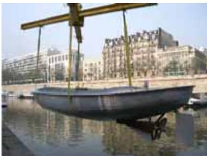
La mise à l'eau est rapide nous descendons à bord pour vérifier l'étanchéité. Une fuite sur deux lignes de rivures arrière bâbord et une autre sur une partie de la ligne de rivures tribord, rien de grave, l'eau s'écoule lentement. Nous marquons les rangées défectueuses. Le passe coque bâbord du condenseur fuit également, mais ça ce n'est pas grave, il suffira de resserrer davantage l'écrou de fixation.
