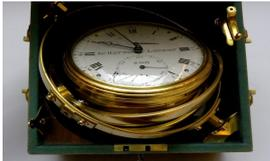
*le système de suspension à cardans*
