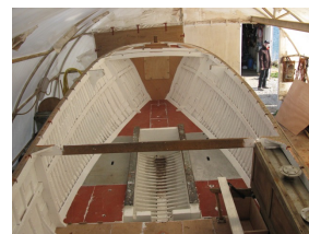
17-Autre vue de l'intérieur et du plancher sur l'avant. À noter à droite, la présentation du réservoir bâbord et de son support (qui constitue aussi les pieds de banc de la chambre) à mettre en place avant le montage du pont.
