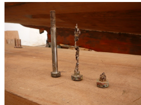
8-Les deux vis de droite sont ce qui reste des vis extraites lors du démontage de l'étrier de fixation de la sortie de ligne d'arbre; la vis de gauche n'est là qu'à titre de comparaison, et pourtant c'était de l'inox, peut être pas du A4 mais tout de même.
