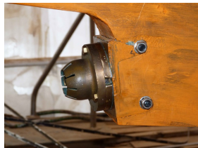
7-Sortie de ligne d'arbre. Noter les deux boulons de fixation de l'étrier, c'est à cet emplacement que se situaient les vis de la photo suivante.
