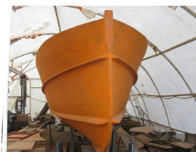
4 - Coque terminée vue de l'avant. Deux couches de minium au plomb (on en trouvait encore)
