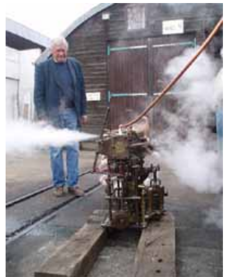
On purge les cylindres
